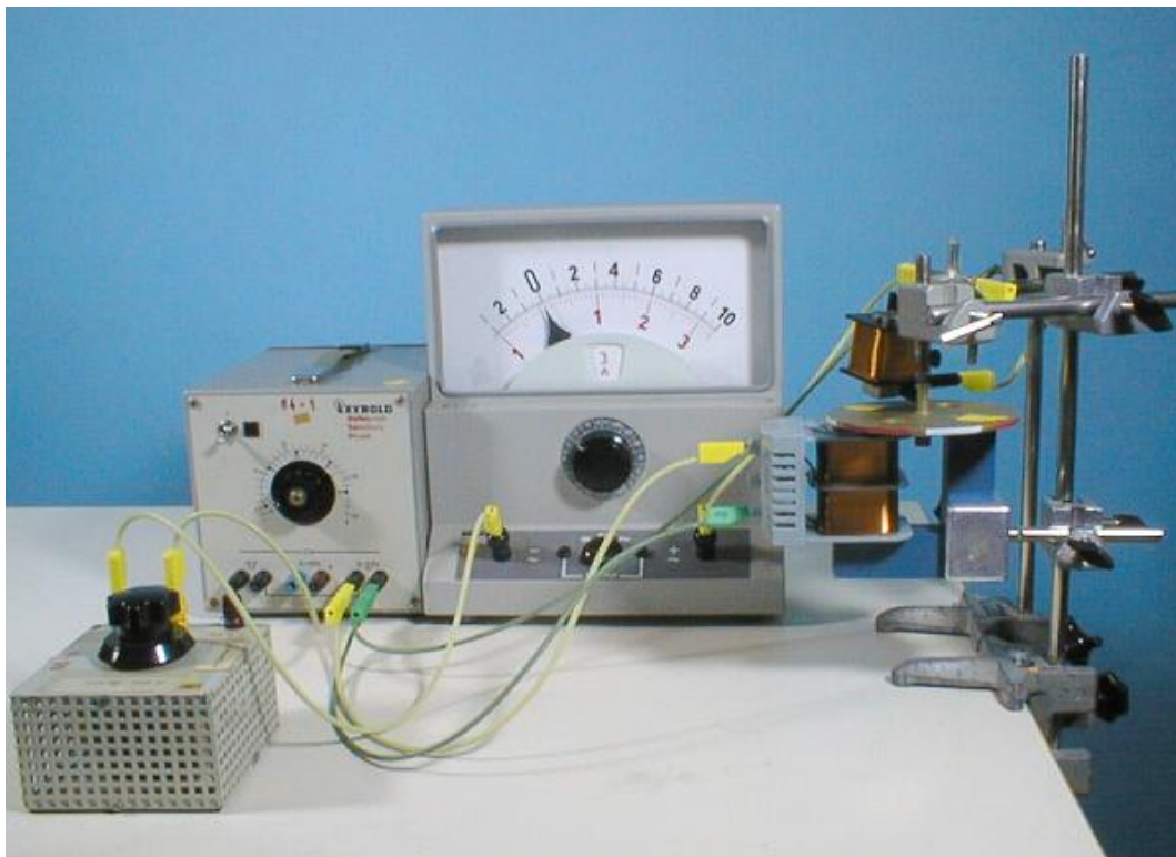
Abbildung 1: Aufbau des Zählers: Strom- und Spannungsspule mit Drehscheibe
